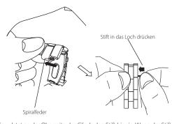
(2) Drücken Sie zuletzt an der Oberseite des Glieds den Stift hinein. Wenn der Stift nicht mittig im Glied sitzt, besteht die Gefahr, dass er beim Tragen der Uhr herausrutscht. Kontrollieren Sie die Simple Adjust-Gelenkstruktur, um sicherzugehen, dass er richtig eingesetzt ist.
